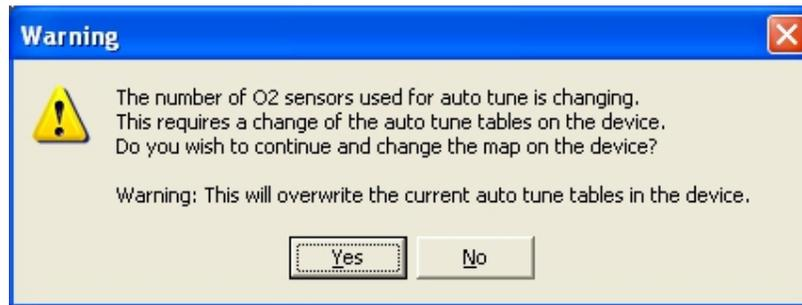
*Il numero delle sonde lambda utilizzate per l' auto tune sta per essere cambiato.
